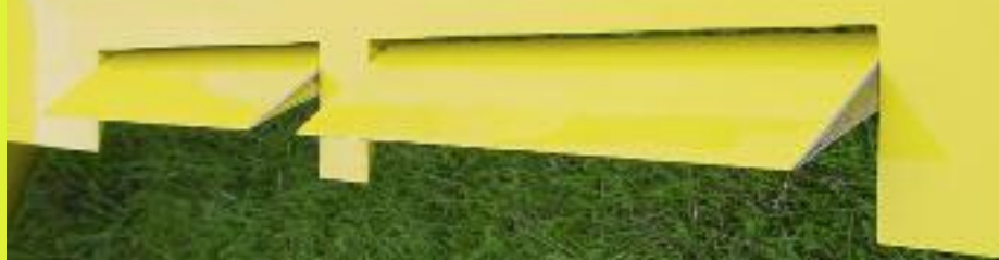
Metamorphose einer Endleiste. Zwei Drehbremsklappen sitzen an jeder Flächenseite. Sie werden über jeweils eine Torsionsstange angesteuert. Das zugehörige Servo sitzt ebenfalls in der Fläche. Ausschläge bis 90 Grad sind möglich. In der eingefahrenen Endstellung verriegelt das Servo quasi über die Kinematik des eigenen Weges.
